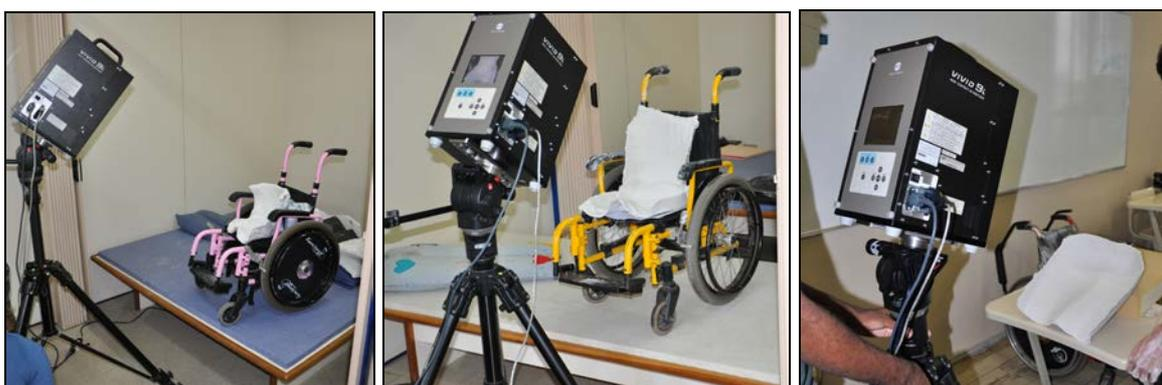
Figura 2 - Digitalização tridimensional dos moldes obtidos na AACD.
