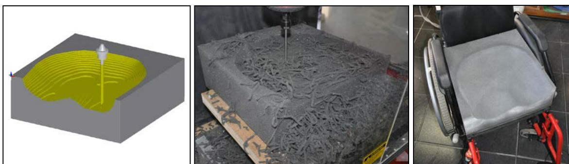
Figura 4 - Exemplo de assento personalizado confeccionado via usinagem CNC.
